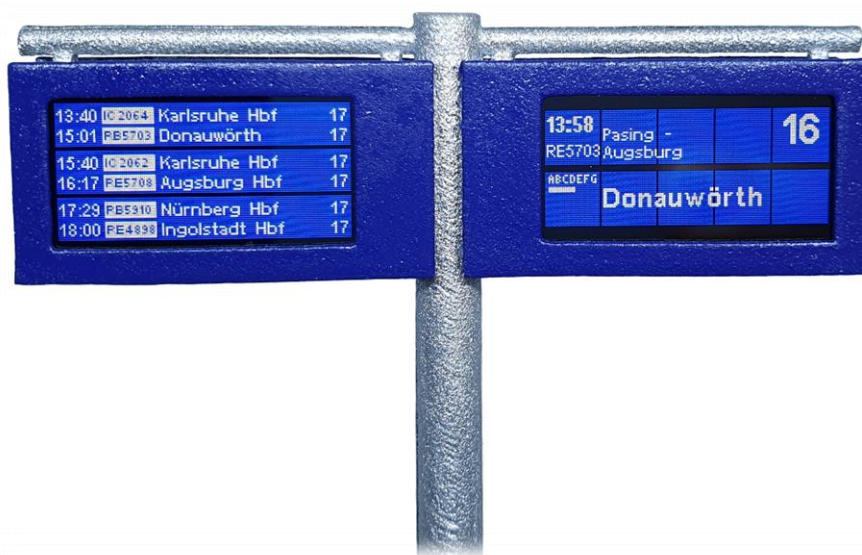
Abb. 1: Zugzielanzeiger TFT96_4 als kombinierter Übersichts- und DB Bahnsteiganzeiger
