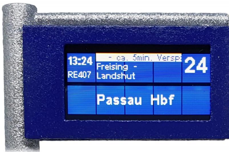
Abb. 1: Zugzielanzeiger TFT96_2 als DB Bahnsteiganzeiger
